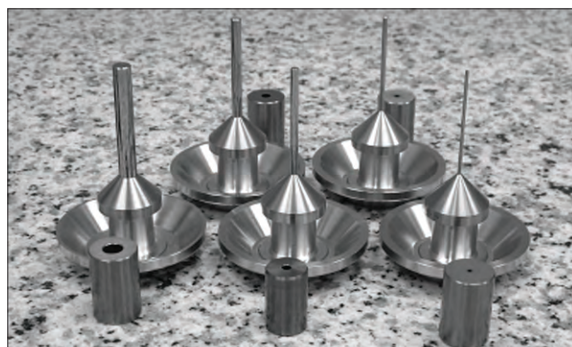
Obr. 4: Sada pístových tlakových měrek státního etalonu pro kapalně médium
