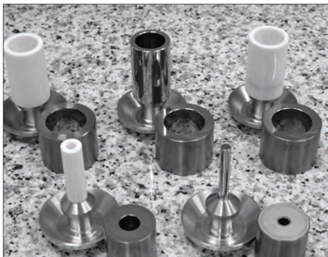
Obr. 2: Sada pístových tlakových měrek státního etalonu pro plynné médium
