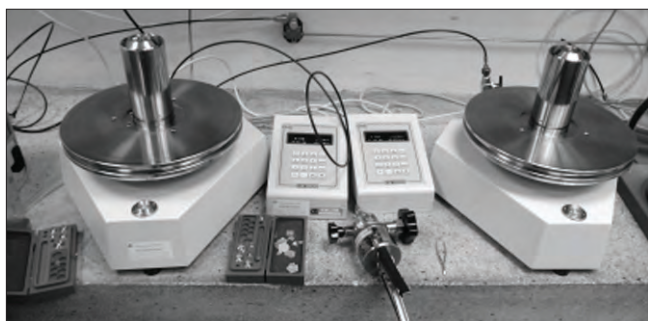
Obr. 3: Státní etalon přetlaku v kapalném médiu
