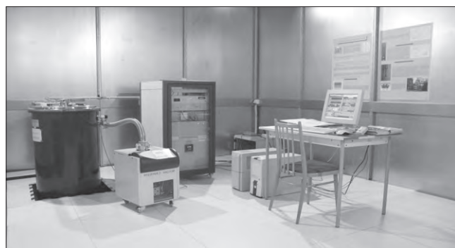
Obr. 4: Pracoviště etalonáže elektrického odporu
