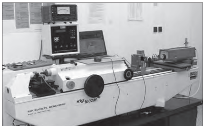
Foto 5: Kalibrace etalonů na délkoměru pomocí laserinterferometru HP (foto-autor)
