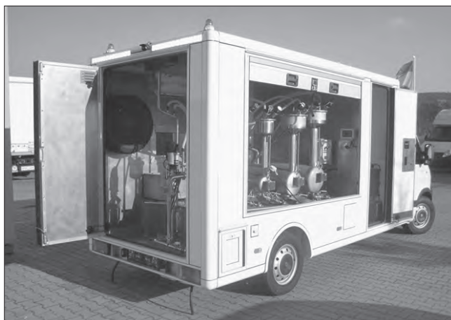
Obr. 9: Speciální mobilní pracoviště ověřování výdejních stojanů
