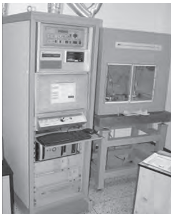
Foto 1: Sestava Tesa NPL v modernizovaném provedení, osazen nový TFT 19" monitor (foto – autor)
