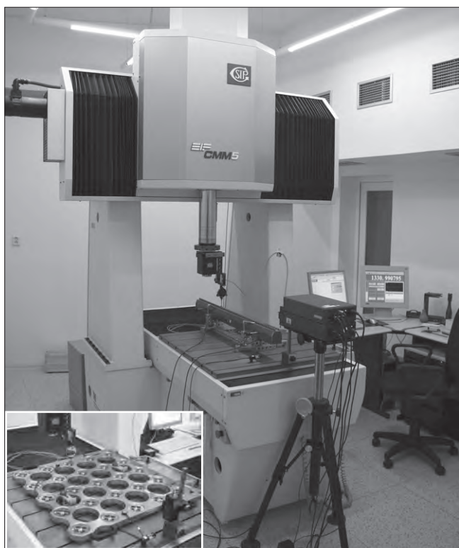
Obr. 2: Souřadnicový měřicí stroj CMM5 SIP
